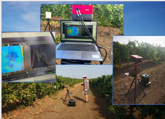
Figura 1. Sistema portatile di imaging iperspettrale SWIR
